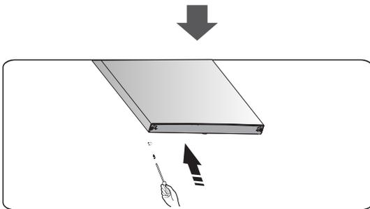
6. Incline el refrigerador sobre el envoltorio de espuma suave o sobre un material similar. Retire las piezas de las patas inferiores ajustables y la pieza de bisagra inferior desatornillando los tornillos autorroscantes de la brida especial.
