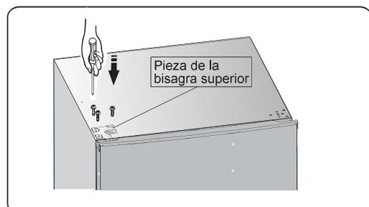
10. Instale el cobertor del orificio del tornillo en el rincón superior derecho del refrigerador. Instale la cubierta de la bisagra superior (que está en la bolsa de plástico) en la esquina izquierda. Coloque la otra cubierta de la bisagra superior en la bolsa de plástico.
