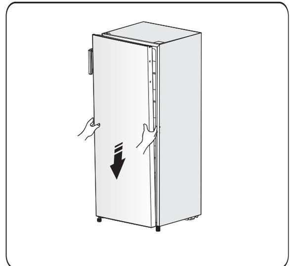
9. Cambie la pieza de la bisagra superior y coloque el eje de la bisagra superior en el orificio superior de la puerta y ajústela en la posición de la puerta (sujete la puerta con la mano mientras lo haga), fijando la pieza de la bisagra superior con los tornillos autorroscantes de la brida especial.
