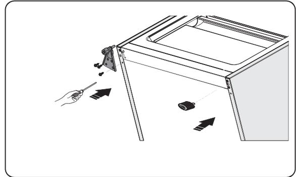
8. Cambie la puerta a la posición de propiedad, ajuste la pieza de bisagra inferior colocando el eje de bisagra en el orificio inferior de la puerta.
