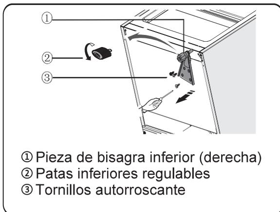
7. Vuelva a colocar la pieza de arandela inferior en el lado izquierdo y fíjela con los tornillos autorroscantes
