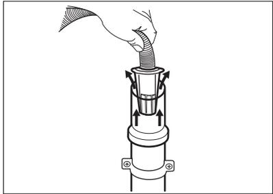
4. A un tubo vertical con orificio de ventilación - Introduzca directamente la manguera de descarga en un tubo. Consulte la ilustración.
