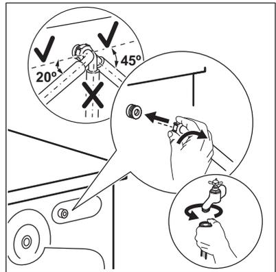
2. Colóquela hacia la izquierda o la derecha en función de la posición del grifo de agua. Asegúrate de que la manguera de entrada no esté en posición vertical.
