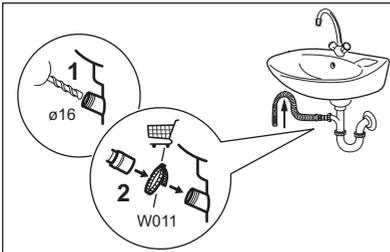
Conecte la manguera de desagüe al sumidero y asegúrela con una abrazadera. Asegúrese de que la manguera de desagüe realiza un bucle para evitar que las partículas entren en el aparato desde el fregadero.
