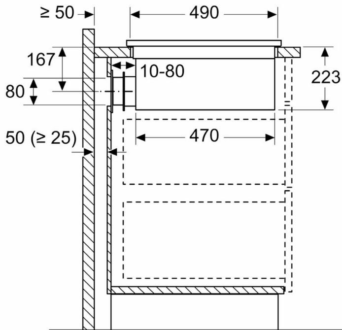
Al realizar la instalación directamente en paredes exteriores no aisladas ( $\mu \geq 0,5 \text{ W/m}^2 \text{ } ^\circ\text{C}$ ), recomendamos el uso de configuraciones de recirculación total o parcialmente canalizada.
