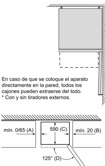
En caso de que se coloque el aparato directamente en la pared, todos los cajones pueden extraerse del todo.
