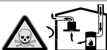
Los equipos calefactores que dependen del aire del recinto de instalación (p. ej., calefactores de gas, aceite, madera o carbón, calentadores de salida libre, calentadores de agua) adquieren aire de combustión del recinto de instalación y evacuan los gases de escape al exterior a través de un sistema extractor (p. ej., una chimenea).
