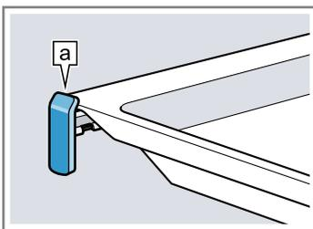
**Nota:** Cuando se saca completamente, los rieles de extracción se encajan en su lugar. Volver a introducir los rieles de extracción en el compartimento de cocción ejerciendo un poco de presión.
