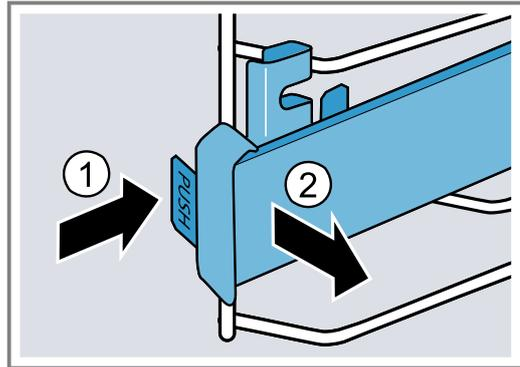
3. Tirar del riel hacia delante hasta que la sujeción se desenganche en la parte trasera.
