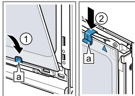
4. Enganchar el cristal delantero por abajo en las sujeciones izquierda y derecha [a] ①.
