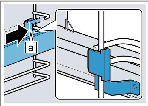
3. Mantener pulsado **PUSH** ① e inclinar el riel de extracción hacia dentro hasta que la sujeción delantera [a] quede situada entre ambas guías ②.
