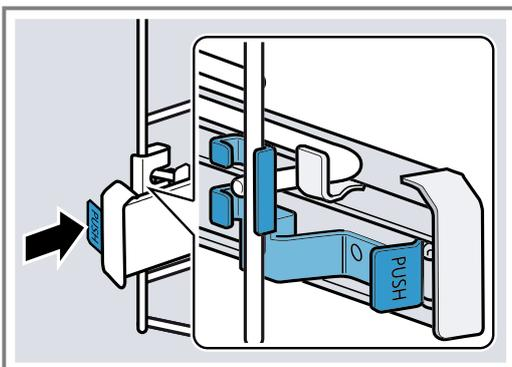
1. Insertar el riel de extracción entre las dos guías.
