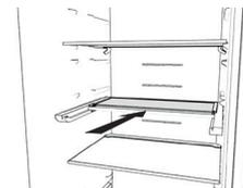
3. Plegado hacia arriba si necesita hacer espacio para objetos altos o voluminosos en el estante de abajo. Para plegar el estante hacia arriba, ajústelo primero en la posición a medio camino desde la profundidad media. Despliegue el estante hacia abajo para volver a utilizarlo en la profundidad media y en la profundidad total.
