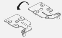
24. Retire la tapa del orificio del tornillo (1) en la parte superior izquierda y colóquela en el lado derecho (2).
