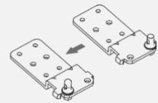
15. Fije la bisagra izquierda (1) con los tornillos (4) y atornille la pata (3).
