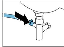
Asegurar el punto de conexión con una abrazadera (24-40 mm).
