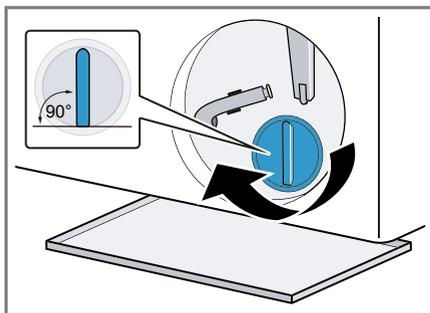
El asa de la tapa de la bomba debe estar en posición vertical.
