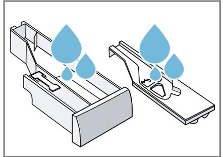
9. Secar y colocar el compartimento para detergente, la tapa y la unidad de bomba.
