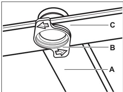
1. Libere los topes en los lados de los rieles deslizantes del cajón de cubiertos y saque el cajón.
