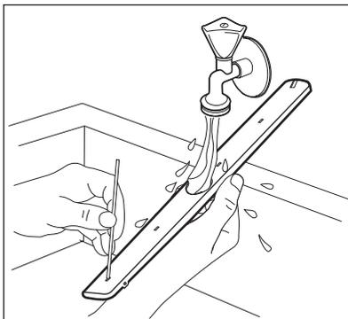
5. Para instalar el brazo aspersor (C) de nuevo, inserte el elemento de montaje (B) en el brazo aspersor y fíjelo en el tubo de descarga (A), girándolo en sentido de las manecillas del reloj. Asegúrese de que el elemento de montaje encaje en su sitio.
