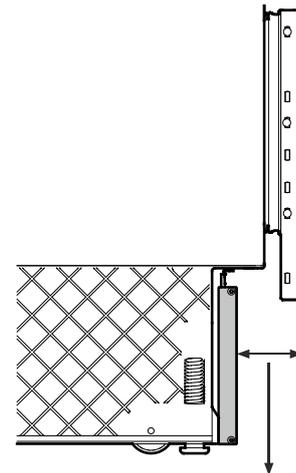
La rejilla de aireación suministrada junto con el aparato se puede ajustar en profundidad después del montaje.
