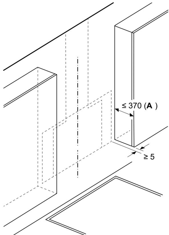
**A:** Profundidad máx. del armario superior (puerta incl.) para el montaje de la placa de cristal
