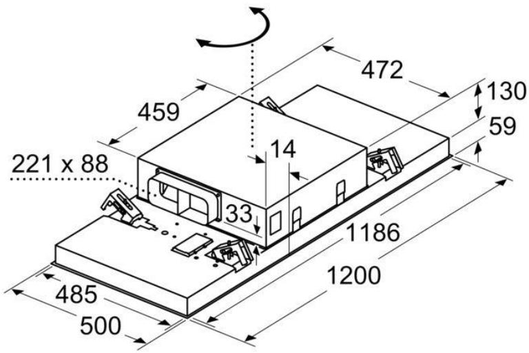
La salida del ventilador puede girarse en las cuatro direcciones
